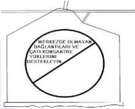
SİLO DOLUMU NCESİ ISI KONTROL KABLolarının ŐEKİLDEKİ GİBİ ZEMİNE BAđLI OLMAMASI DURUMUNDA ATI HASAR GRECEKTİR !!!
